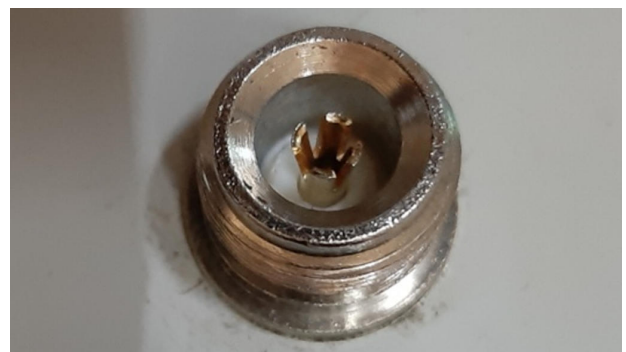
Abb. 3: defekte Buchse am Tuner - Quelle: Thomas (DB5FT)
