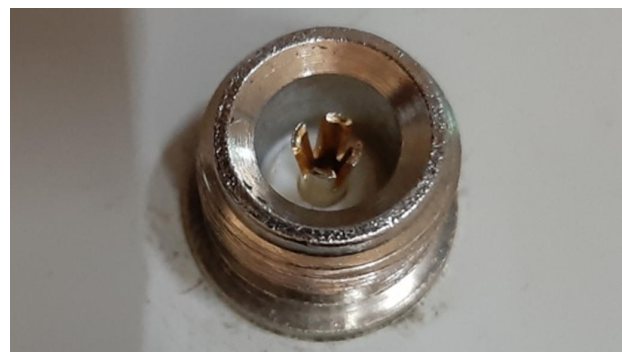
Abb. 3: defekte Buchse am Tuner - Quelle: Thomas (DB5FT)
