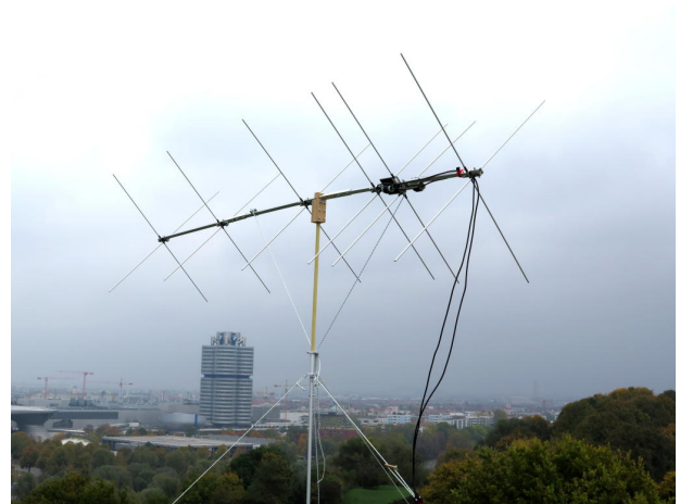
Abb. 1: 2m 6El. Yagi nach DK7ZB, als Kreuzyagi ausgeführt
