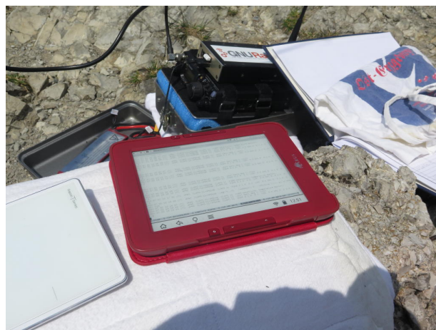
Abb. 4: Station aus FT817, Raspberry Pi und Einkreader
