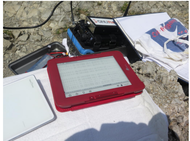
Abb. 4: Station aus FT817, Raspberry Pi und E-Inkreader - Quelle: Sven (DG1SVE)
