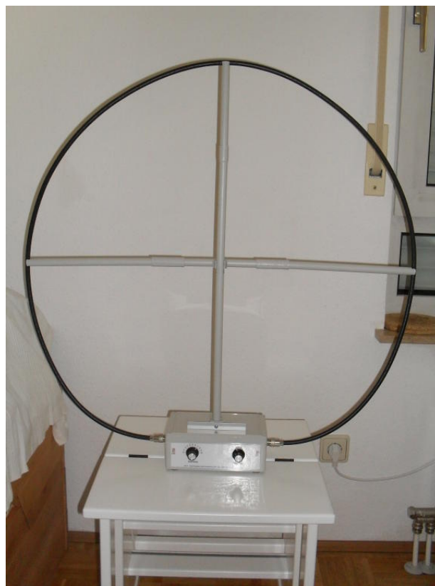
Abb. 2: Aufbau der QRP-Magnetloop Antenne
