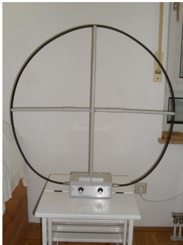
Abb. 2: Aufbau der QRP-Magnetloop Antenne - Quelle: Wolfgang (DB2MWA)
