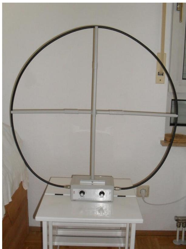
**Abb. 2:** Aufbau der QRP-Magnetloop Antenne -
