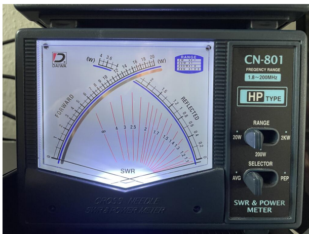
Abb. 1: Ein Kreuzzeiger SWR- und (Durchgangs-) Leistungsmesser. - Quelle: Wolfgang (DB2MWA)
