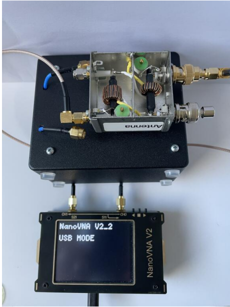
Abb. 5: Der Richtkoppler im Messaufbau am NanoVNA, hier bereits an der Rückwand des fertigen Geräts. - Quelle: Wolfgang (DB2MWA)
